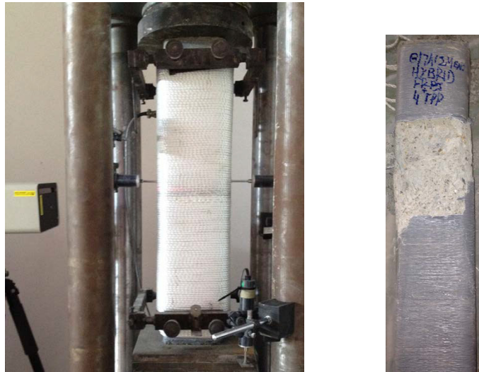
Σχήμα 1. Πειραματική διάταξη για το RCGL1PPL4 (α). Το υποστύλωμα μετά το τέλος του πειράματος και την απομάκρυνση του PPFR (β).
