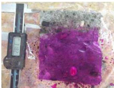
Σχήμα 4. Εκτίμηση βάθους ενανθράκωσης (αριστερά) και μικροσκοπική παρατήρηση σκυροδέματος πυρήνων (δεξιά) – γέφυρα Βενέτικου
