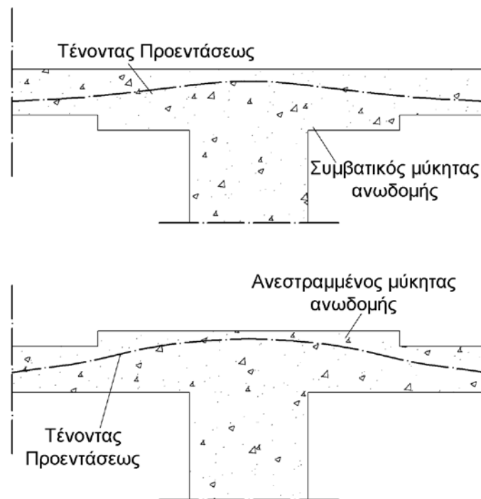
Σχήμα 1. Διαφορά συμβατικού με ανεστραμμένο μύκητα πλάκας δώματος ως προς τη γεωμετρία του δομικού στοιχείου, και την καμυλότητα του τένοντα προεντάσεως
