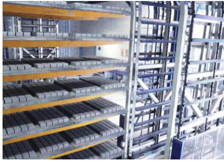
Σχήμα 5. Αποθήκευση προϊόντων σκυροδέματος και πρόωρη ωρίμανση σε μεταλλικά ράφια
