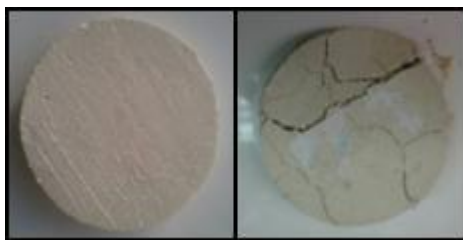
Σχήμα 7: επίδραση των θεικών αλάτων στην αερακτική άσβεστο
