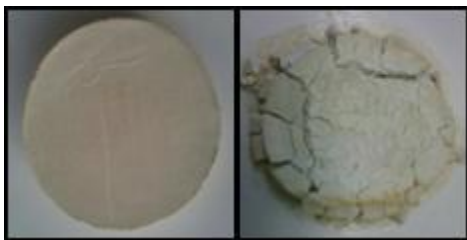
Σχήμα 6: επίδραση των θεικών αλάτων στο τσιμέντο Portland
