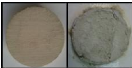
Σχήμα 8: επίδραση των θεικών αλάτων στην υδραυλική άσβεστο
